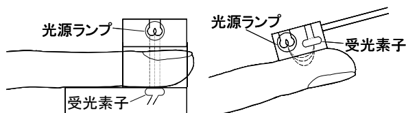
図 74 光電式容量脈波計透過式 (左) と反射式 (右)
